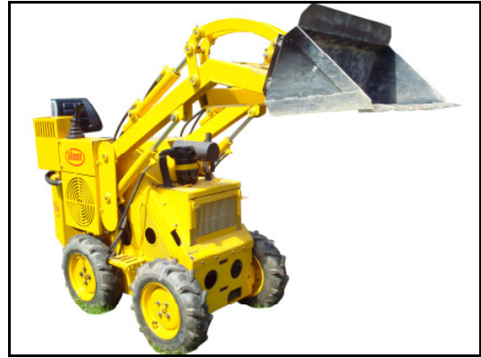
Concha da Pá Baixada: alavanca (2) para frente
