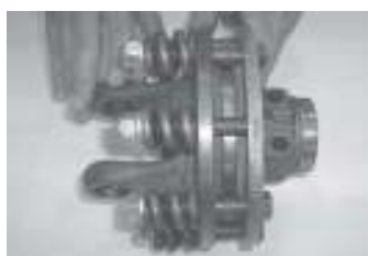
Colocação dos parafusos, porcas arruelas e molas
