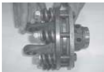
Colocação dos parafusos, porcas arruelas e molas
