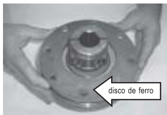
Colocação do disco ferro sobre o conjunto
