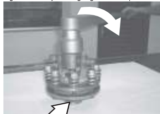
Figura 04 - Aferição da regulagem com torquímetro
