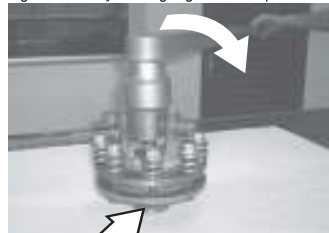
Figura 04 - Aferição da regulagem com torquímetro
